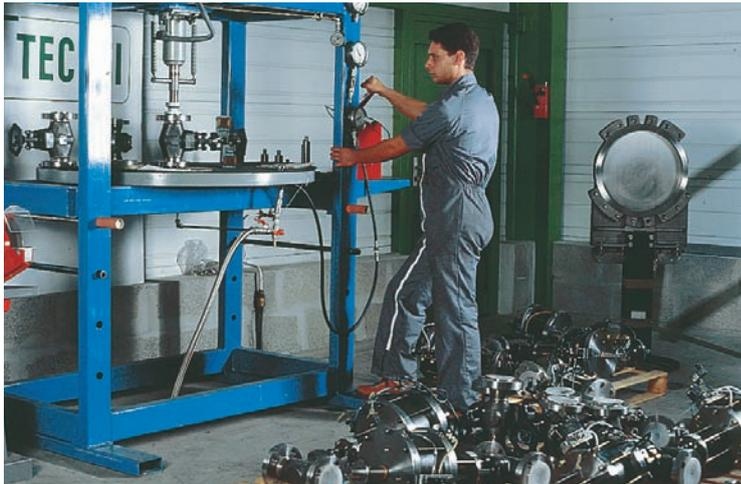
ТЕКОФИ располагает самым современным оборудованием для осуществления контроля и испытаний: гидравлическим и пневматическим для испытаний на герметичность, габаритный контроль и контроль материалов конструкции, испытание на усталость конструкции.
