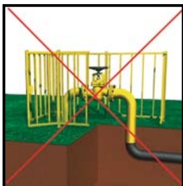
Наземная установка задвижки
